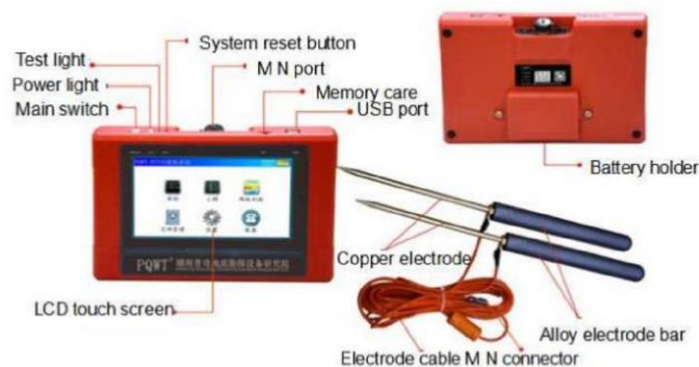
Gambar 2. Peralatan PQWT TC150 (PQWT, 2018a)
