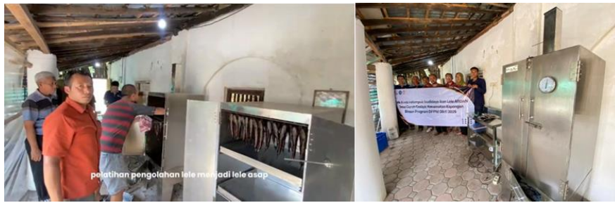
Gambar 2. Proses pengasapan lele menggunakan alat pengasap berbahan bakar sabut kelapa dengan sistem rak susun.
