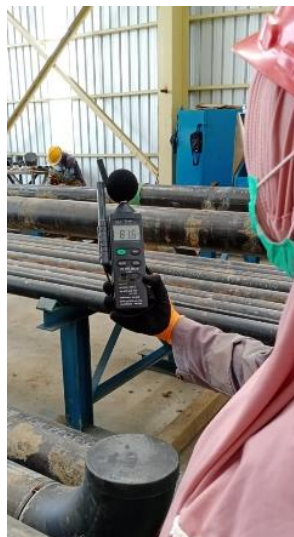
Gambar 1. Pengukuran kebisingan menggunakan sound Level Meter
