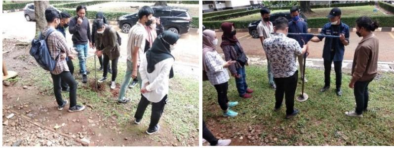
Gambar 4. Percobaan pembuatan lubang biopori dengan bor berdiameter 10 cm dan peralatan untuk praktik mekanika tanah
