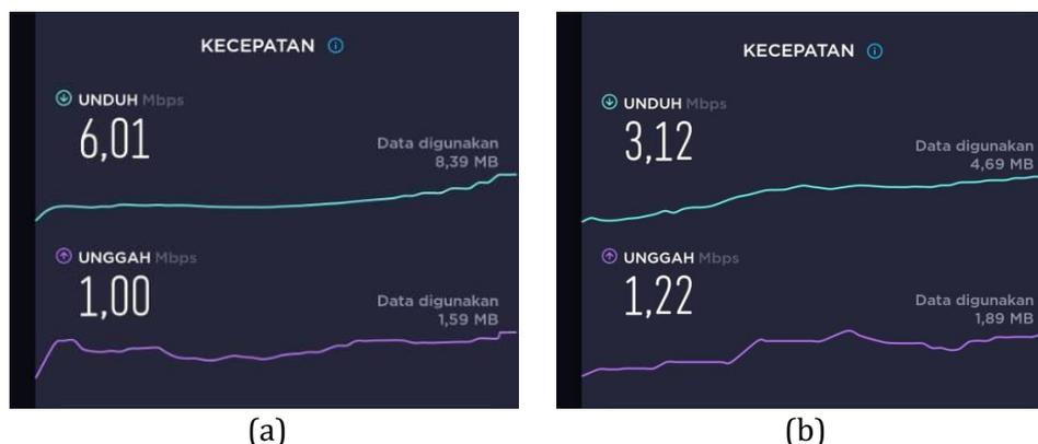
Gambar 4. Hasil Pengukuran menggunakan speed test (a) Hasil pengujian pada jarak 1 meter dari antena *indoor* (b) Hasil pengujian pada jarak 10 meter dari antena *indoor*
