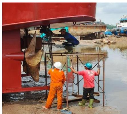
Gambar. 4 Pemasangan baling kapal
