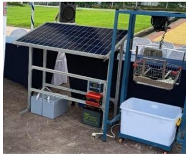
Gambar 1. Prototipe Alat Celup Batik Bertenaga Surya
