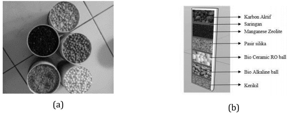
Gambar 7. (a) Komponen Filter yang Dimasukkan dalam Paralon (b) Urutan Komponen Filter
