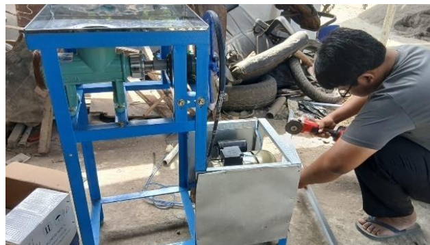
Gambar 4. Mesin pencacah sampah organik yang diimplementasikan
