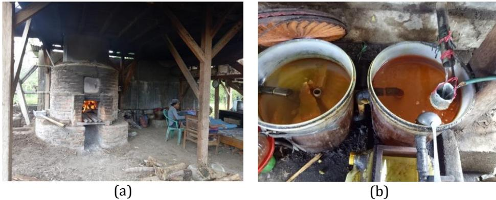
Gambar 1. (a) Proses penyulingan minyak nilam, (b) produk minyak nilam
